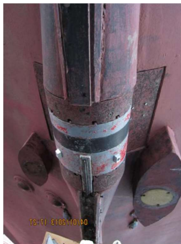
Figure 15 : Illustration de la base d'un sondeur multifaisceaux (de type Reson 7101) sur la coque de la vedette hydrographique « Hyphos »
